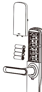
飞利浦智能锁基础工作电源为4节5号碱性电池。电池盒内设两组工作电源, 可安装8节电池, 延长续航时间, 减少更换电池次数。
