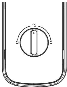
在易锁处于已上锁状态时，扭动旋钮至左边或右边的上锁刻度处（如左图所示），启用室内反锁。反之，扭动旋钮至中间的开锁刻度处，解除室内反锁。
