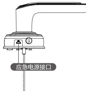
当电池电压不足, 无法从外部开启时, 您可以通过使用5V充电宝作为应急电源通过Micro USB接口给门锁上电。打开门锁后, 请立即更换电池。
