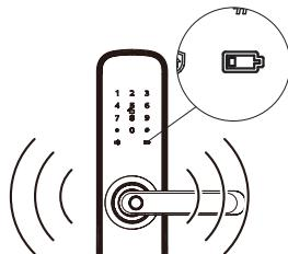
**触发:** 当系统唤醒后, 将自动检测电池电压, 当电池电压不足时, 发出警报, 提示您及时更换电池。
